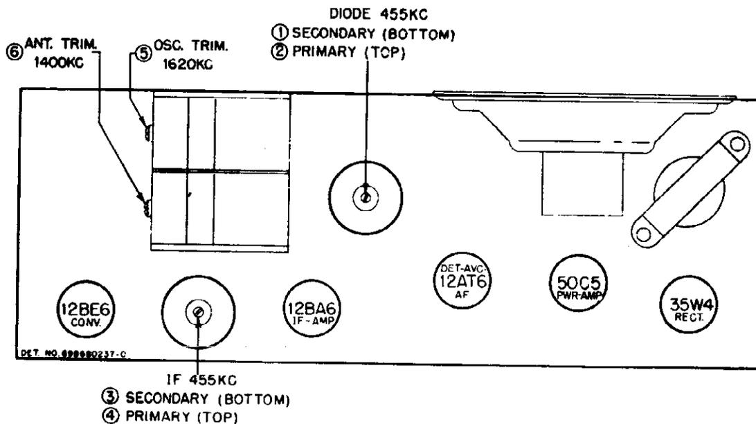
FIGURE 2. TUBE & TRIMMER LOCATION
